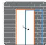
Die Deckzarge wird zum Schutz vor Beschädigungen während der Bauphase entnommen
