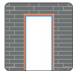
Unterzarge und Deckzarge sind im Lieferzustand miteinander verschraubt und werden zusammen montiert
