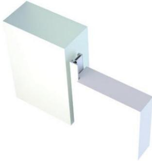
Einbausituation: Mauerwerk, reverse öffnend
